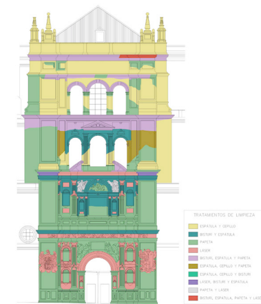
Tratamientos Portada Perdón: Portada del Perdón. Catedral de Granada. Tratamientos de limpieza (2003).
